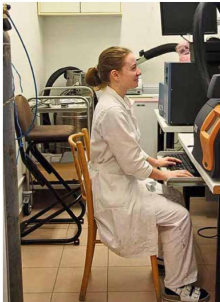
Diferenční skenující kalorimetr pro měření zmražené vody v rostlinách obsluhuje Bc. Martina Hradcová
