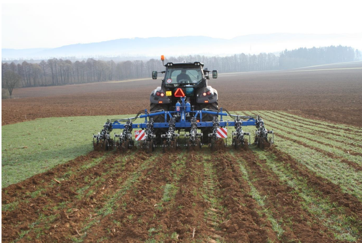
Obrázek: ECO TILLER - stroj pro pásové zpracování půdy
